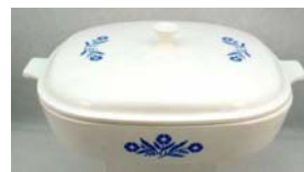
Pyroceram TM – sustav \text{Li}_2\text{O}-\text{Al}_2\text{O}_3-\text{SiO}_2 Corning Ware 9608 - bazirana na \beta -spodumenu, \text{LiAlSi}_2\text{O}_6-\text{SiO}_2
