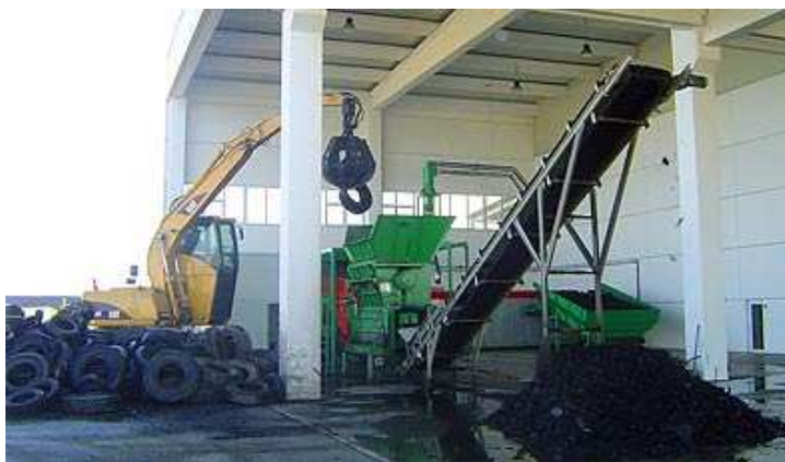
Slika 32 - Postrojenje za recikliranje otpadnih auto-guma
