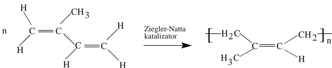
Slika 30 - Dobivanje sintetskog kaučuka polimerizacijom izoprena
