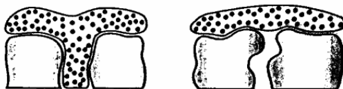
Slika 5.40. Shema deaktivacije katalizatora naslagama na površini
