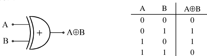
Slika 3.2. - Sumator po modulu 2 (ekskluzivno ILI)
